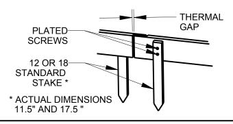
3b USE A STEEL"J" STAKE LEAVING A GAP FOR THERMAL EXPANSION
