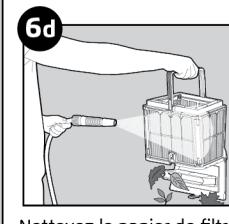
Nettoyez le panier de filtrage au moyen d'un jet d'eau.
